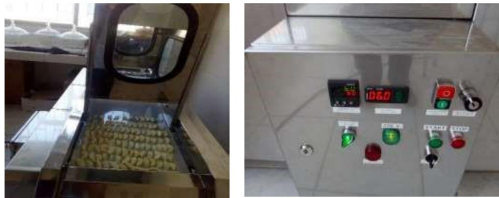
Figura 3. Equipo de deshidratación por ventana refractiva.
