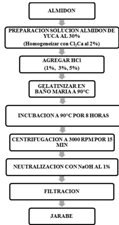
Figura 2. Diagrama de proceso de Hidrólisis enzimática aplicado al almidón de Yuca.
